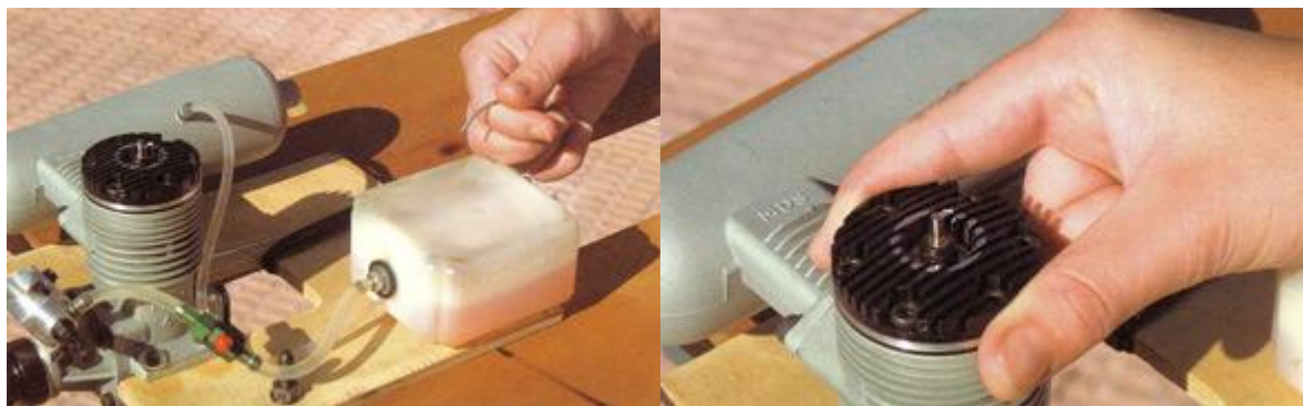
1) Installation du réservoir sur un banc de rodage.
